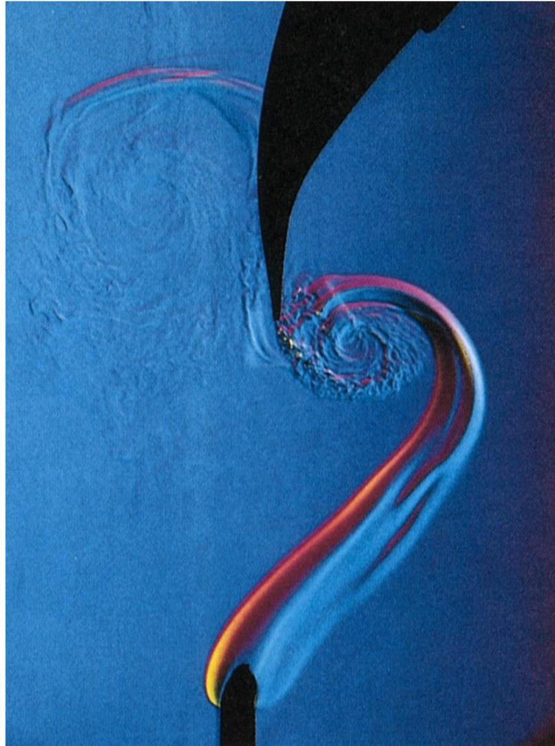
A principio el humo asciende mediante un flujo regular, el **flujo laminar**, pero rápidamente este movimiento se hace **turbulento**, de tal forma que el humo hace remolinos irregulares.
