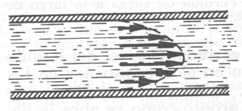
Cuando la velocidad de flujo de un fluido resulta suficientemente grande, se rompe el flujo laminar y se establece la turbulencia (**Número de Reynolds**  $> 3000$ )
